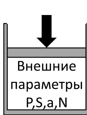
Рис. 4.4. ТД система под теплоизолирующим поршнем с теплоизолирующими стенками
